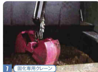
7 固化専用クレーン
